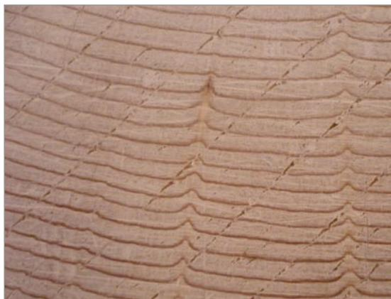
Foto 2 - Legno indentato, sezione trasversale.
