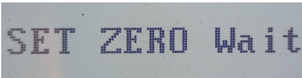
Figura 6.1 — SET ZERO Wait — procedura in corso, tenere le sonde ferme e in pressione
