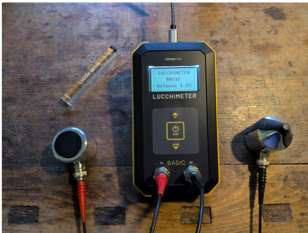
Figura 1.1 — LucchiMeter BASIC con sonde collegate e barra di riferimento su piano di lavoro artigiano
