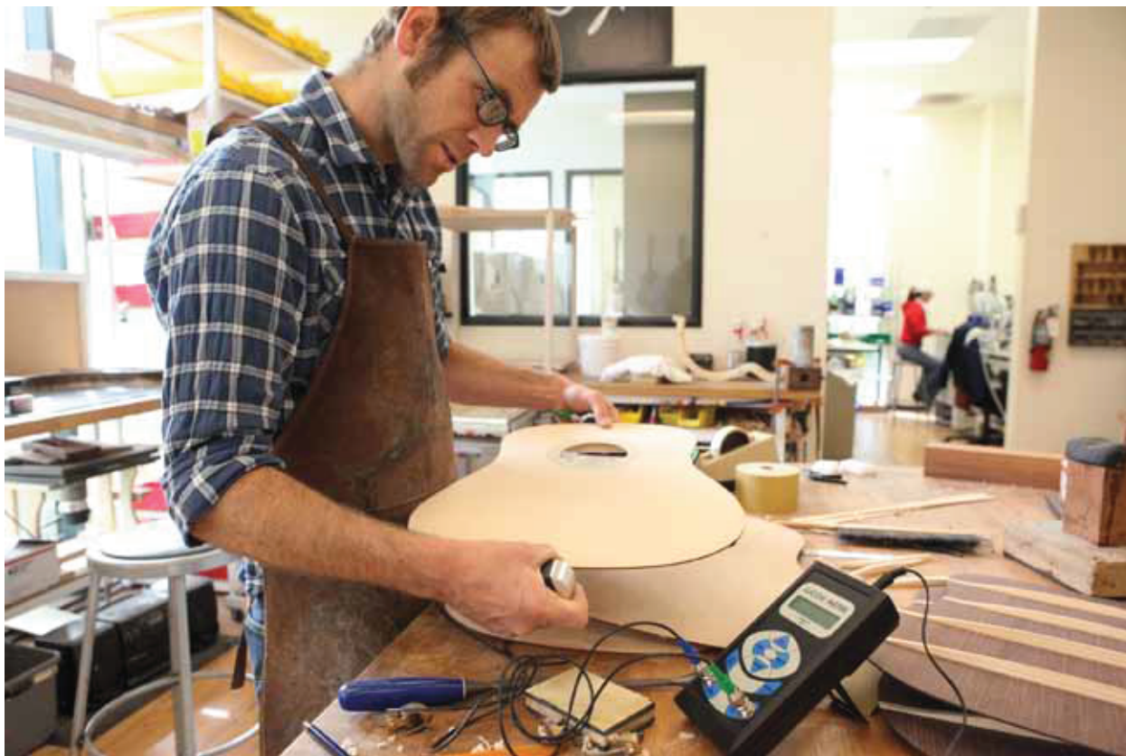
Il Master Guitar Designer Andy Powers mentre usa il LucchiMeter su una chitarra nei laboratori della Taylor Guitars
